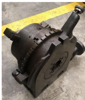
Ref. 280/V146 Plato divisor horizontal y vertical dia. 250 mm. con plato universal de 3 garras Ø 200 mm.
