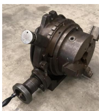
Ref. 280/V146 Plato divisor horizontal y vertical dia. 250 mm. con plato universal de 3 garras Ø 200 mm.
