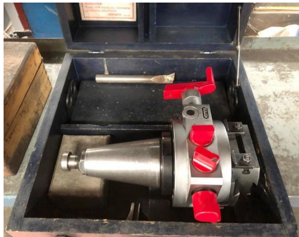
Ref. 280/S086. Cabezal de mandrinar D'ANDREA mod. TA-120 ISO-50. Ø cuchilla 8 mm. Precio 1.500,- €
