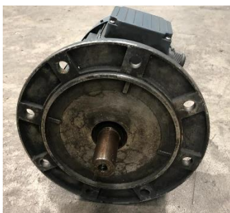
Ref. 280/V149 motor de brida 3 CV dia. eje 28 mm.
