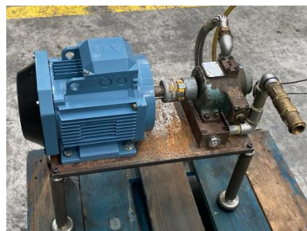
Ref. 280/V210 motor ABB de 2,2 KW - 1450 rpm. Con bomba hidráulica VICKERS 20 l/min – 52 bar
