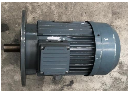
Ref. 280/V149 motor de brida 3 CV dia. eje 28 mm.
