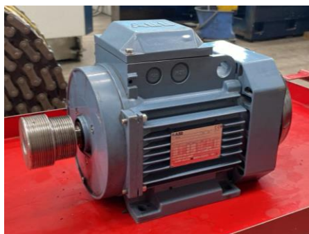
Ref. 280/V208 motor ABB 1,1 KW. De pata 930 rpm Ø eje 24 mm.
