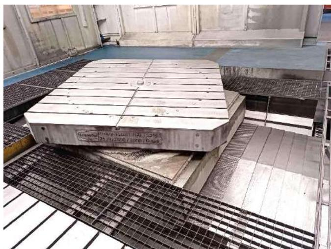
Mesa rototranslante vasculante motorizada  $\pm 5^\circ$  DEMMELER
