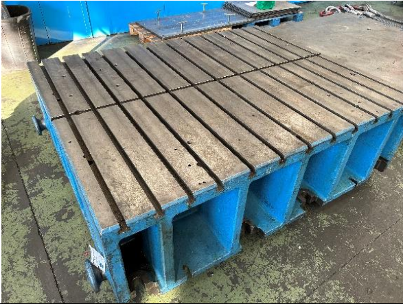
Ref. 280/TMV15. Mesa ranuras con 15 ranuras en T. Dimensiones 1800x1500x560mm
