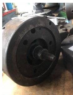
280/V179 Plato neumático FORKARDT 3 garras Ø 250 mm.
