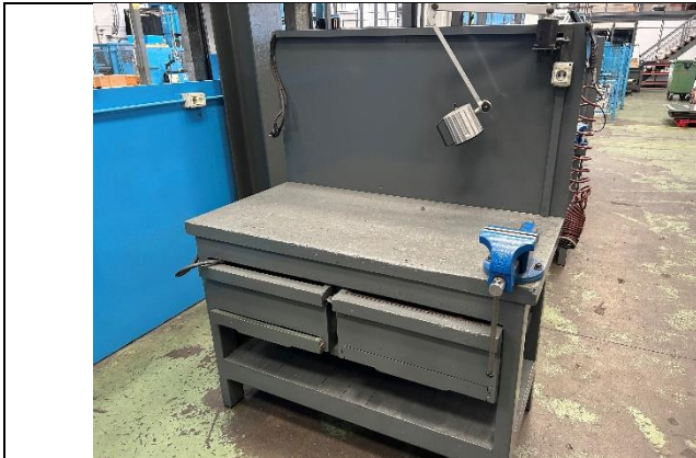
Ref. 280/TMV10 Banco de trabajo 1400x680 mm con doble caj3n, tornillo, toma de aire y luz. (10 unidades)
